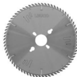
Die empfohlene Schnittgeschwindigkeit beträgt 60 bis 90 m/sec. Bei Kreissägen mit DP-Spitze muss der höhere Wert gewählt werden. Streben Sie einen Vorschub pro Zahn von 0,07 bis 0,08 mm an. In unserem YouTube-Kanal finden Sie weitere Informationen zum optimalen Sägeblattüberstand.
